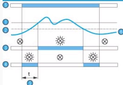
Le relais MIC contrôle la surintensité. Le relais se colle lorsque le courant dépasse le seuil affiché en façade et se décolle lorsqu'il descend en dessous du seuil moins l'hystérésis.
