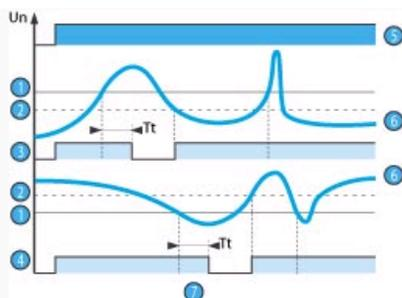
En mode sur tension, si la tension contrôlée dépasse le seuil réglé pendant un temps supérieur à celui réglé en face avant (de 0,1 à 3 s), le relais de sortie s'ouvre et la LED R s'éteint. Pendant la temporisation, cette LED clignote.
