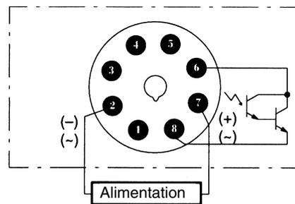
**Note :** les bornes 1, 3, 4 et 5 sont vides. Les bornes 2 et 7 sont identiques à celles du H3CR-A8.
