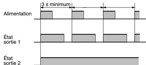
Après l'activation de la fonction de RAZ forcée du H3CR-H, un intervalle de 3 s minimum est nécessaire pour réactiver la fonction de RAZ forcée. Si la fonction de RAZ forcée est activée de manière répétée à des intervalles inférieurs à 3 s, les parties internes du H3CR-H peuvent se dégrader et le H3CR-H dysfonctionner.
