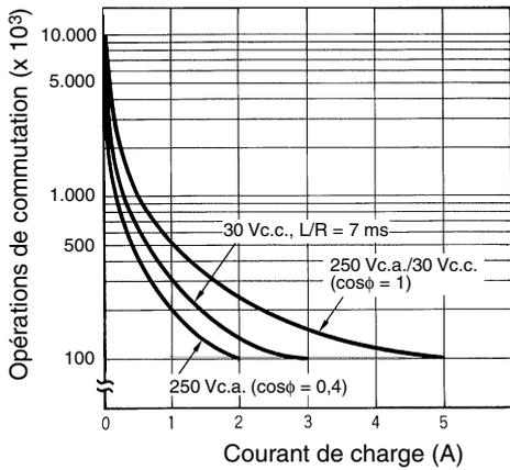
Référence : un courant maximal de 0,15 A peut être commuté à 125 Vc.c. ( $\cos\phi = 1$ ) et un courant minimal de 0,1 A peut être commuté si L/R est de 7 ms. Dans les deux cas, la durée de vie prévue est de 100 000 opérations. La charge minimale applicable est de 10 mA à 5 Vc.c. (niveau d'échec : P).
