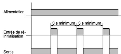
S'il est nécessaire que la sortie soit activée de manière répétée à des intervalles inférieurs à 3 s, il est préférable d'utiliser le H3CR-A en mode D (temporisation au front descendant).
