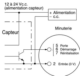
Fonctionne avec transistor activé (ON)
