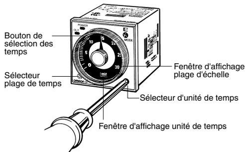
Dans le cas du temps OFF, l'unité de temps désirée (s, 10 s, mn et h ou 10 s, 10 mn, h et 10 h) apparaît dans la fenêtre d'affichage d'unité de temps ON, dans le coin supérieur droit du panneau avant. Vous pouvez la modifier en tournant le sélecteur d'unité de temps OFF situé en dessous de la fenêtre d'affichage d'unité de temps OFF.
