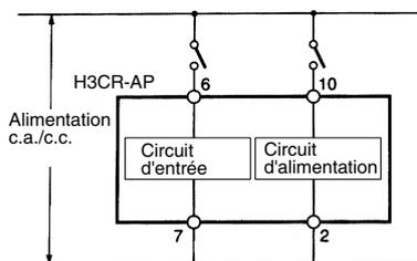
Etant donné que le circuit d'entrée et le circuit d'alimentation sont configurés indépendamment, le circuit d'entrée peut être mis sous ou hors tension indépendamment de l'état ON/OFF de l'alimentation. Il est à noter qu'une tension équivalente à la tension d'alimentation est appliquée au circuit d'entrée.
