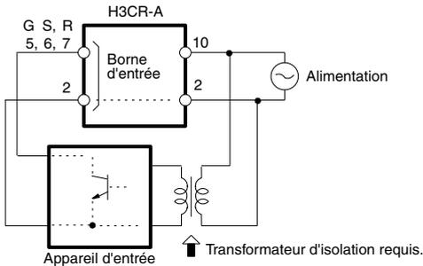
La borne d'alimentation 2 du H3CR-A□/A□S/AP est une borne commune pour les signaux d'entrée à la minuterie. Il convient de ne pas déconnecter les fils de la borne 2, sous peine d'endommager les circuits internes de la minuterie.
