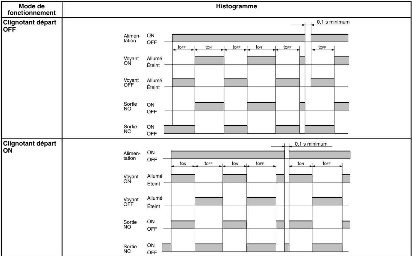
**Note : 1.** Le temps de remise à zéro nécessite 0,1 s minimum.
