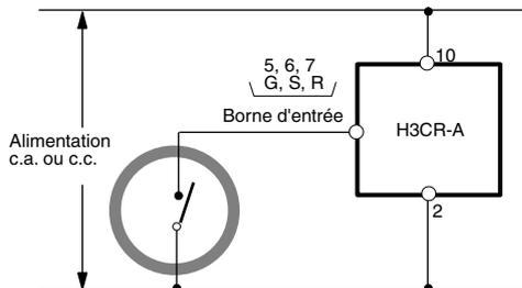
Il convient de ne pas connecter de relais ou d'autre charge entre les bornes d'entrée, sous peine d'endommager les circuits internes de la minuterie en raison de la haute tension appliquée aux bornes d'entrée.
