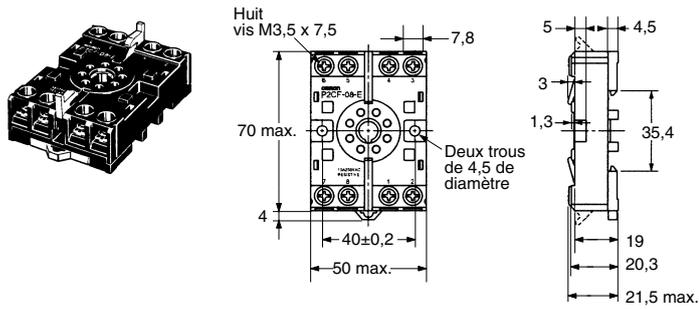
**Montage sur rail / socle de connexion avant**
