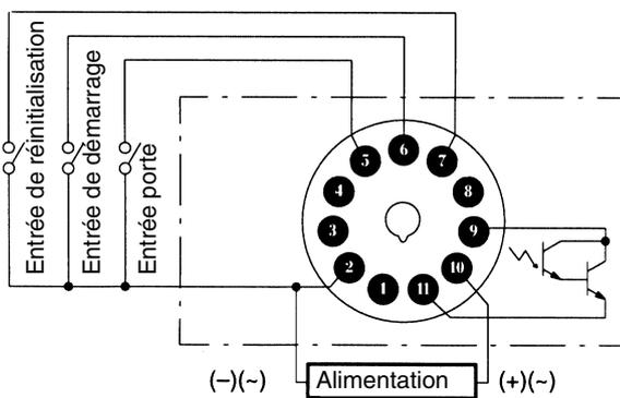
**Note :** les bornes 1, 3, 4 et 8 sont vides. Les bornes 2, 5, 6, 7 et 10 sont identiques à celles du H3CR-A.
