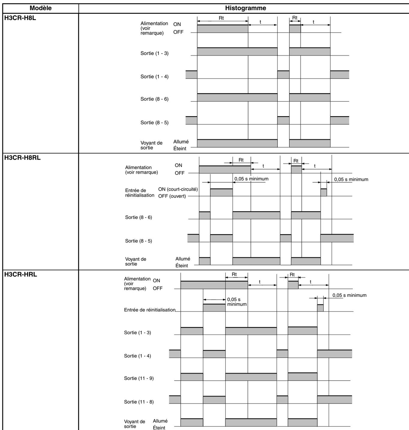
**Note** : s'il y a mise sous tension avant la fin du temps réglé, la minuterie est réenclenchée.
