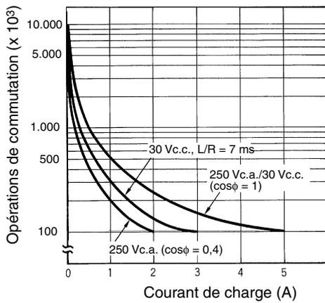
Référence : un courant maximal de 0,15 A peut être commuté à 125 Vc.c. ( $\cos\phi = 1$ ) et un courant minimal de 0,1 A peut être commuté si L/R est de 7 ms. Dans les deux cas, la durée de vie prévue est de 100 000 opérations. La charge minimale applicable est de 10 mA à 5 Vc.c. pour le H3CR-H8L/HRL et de 100 mA à 5 Vc.c. pour le H3CR-H8RL (niveau d'échec : P).
