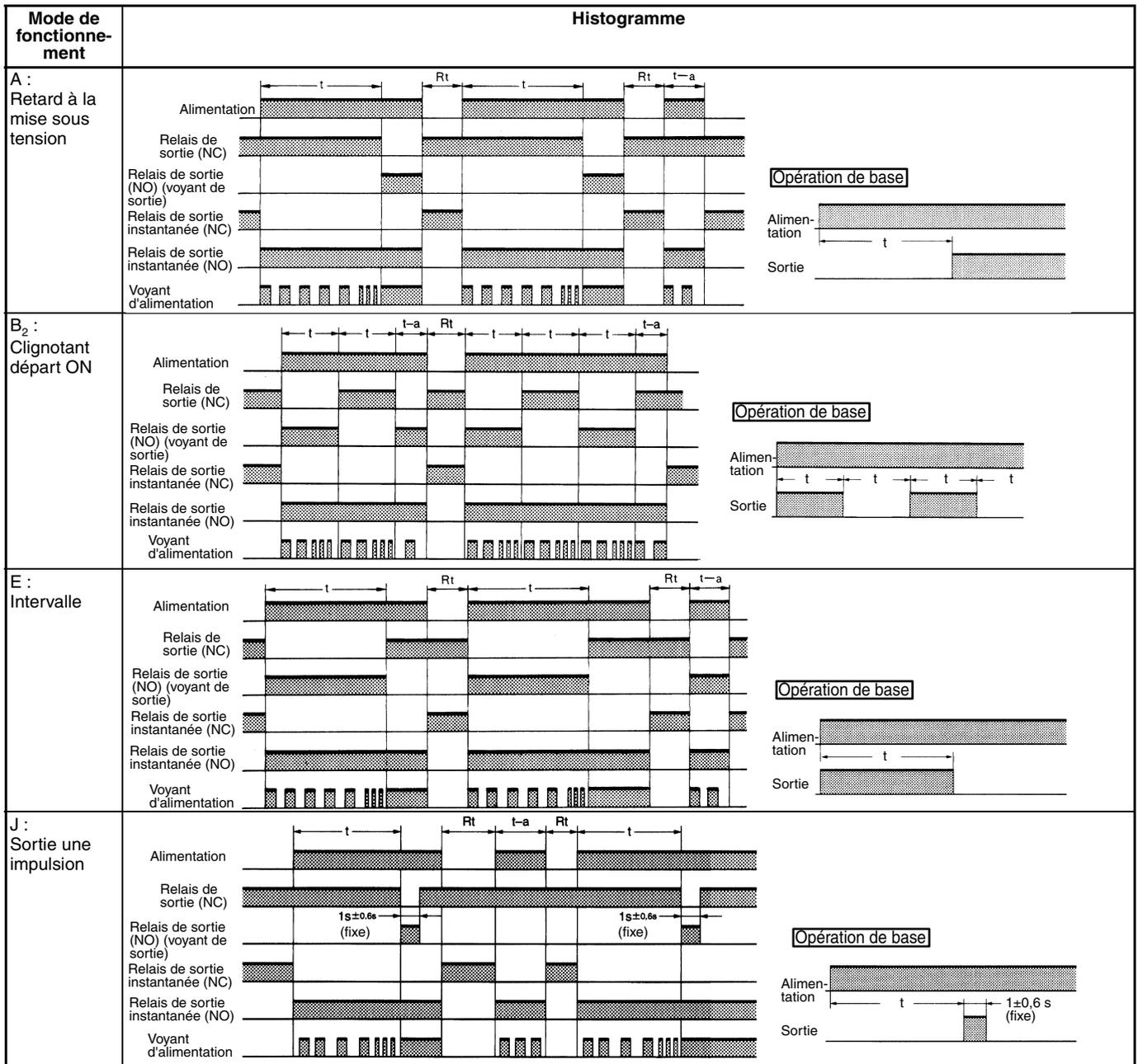
**Note : 1.** Le temps de coupure minimal ("Rt") est de 0,1 s.
