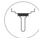
K Etanchéité frontale par joint torique et rondelle. Protège l'interrupteur de l'eau et de la poussière. Cette étanchéité supporte une pression de 1 bar et reste assurée pendant la manoeuvre de l'interrupteur.
