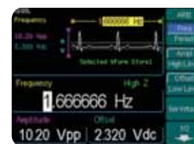
Regénération par le générateur série DG
