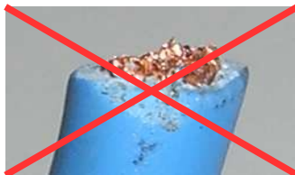
Mauvaise coupe Bad cut
