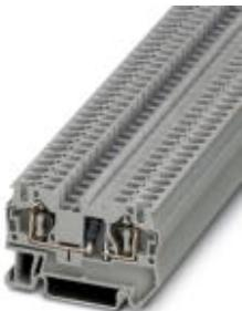
Composant du BJ, Mode de raccordement: Raccordement à ressort, section :0,08 mm<sup>2</sup> - 6 mm<sup>2</sup>, AWG: 28 - 10, Intensité nominale: 1,5 A, Tension nominale: 800 V, Longueur: 56 mm, Largeur: 6,2 mm, Coloris: gris, Montage: NS 35/7,5, NS 35/15
