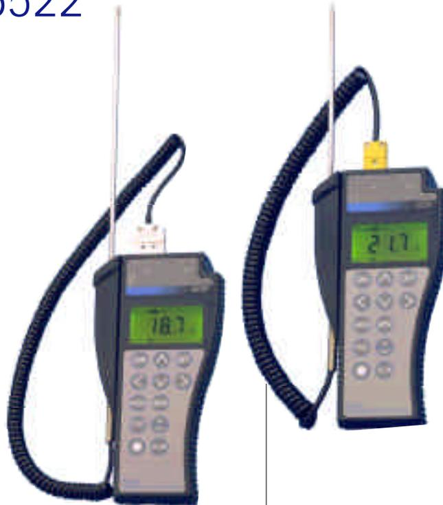
Les thermomètres-calibrateurs permettent de simuler des températures à l'aide de thermocouples (PJ6521) ou de sondes à résistance Pt 100 (PJ 6522) et de mesurer ces mêmes capteurs pour étalonner des appareils de mesure ou de régulation de température.
