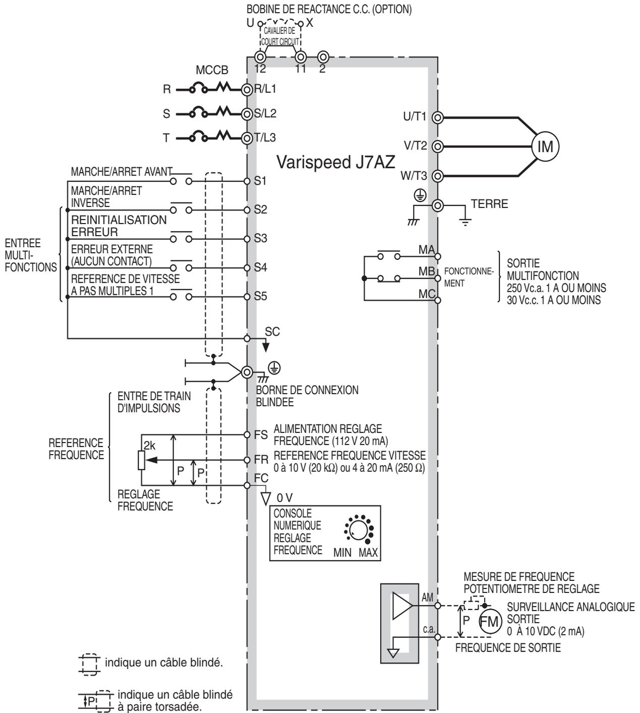
[ ] : indique la connexion pour les deux types suivants de signaux d'entrée de séquence (S1 à S5) : contact sans tension et transistors NPN (0 V commun).
